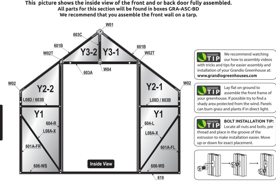
**BACK WALL DOOR** ASSEMBLY ALWAYS ASSEMBLE FRONT HORIZONTAL
